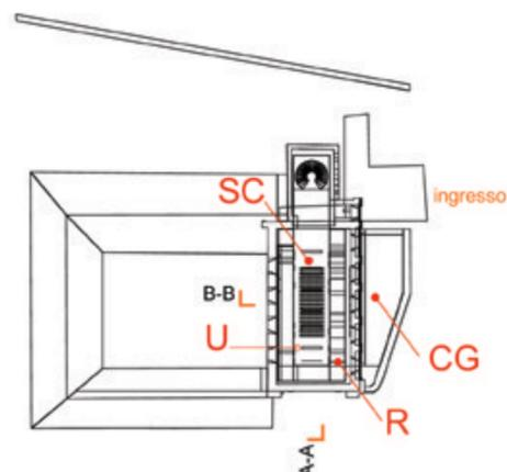
La struttura è costituita dalla copertura rivestita di Cortèn che, appoggiata in sommità alle murature perimetrali, sostiene le flangie d'acciaio a cui sono appesi i solai.
