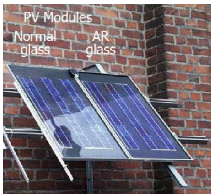
Figura 29: Le due immagini dimostrano in modo lampante come, al contrario di un vetro comune (normal glass), il vetro anti-riflesso (Anti-Reflecting glass) che riveste i moduli fotovoltaici (Photo Voltaic Modules) riduca drasticamente la riflessione dei raggi luminosi.
