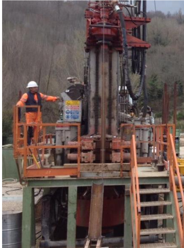
Figura 4: struttura metallica di appoggio per l'installazione del preventer sulla testa del pozzo
