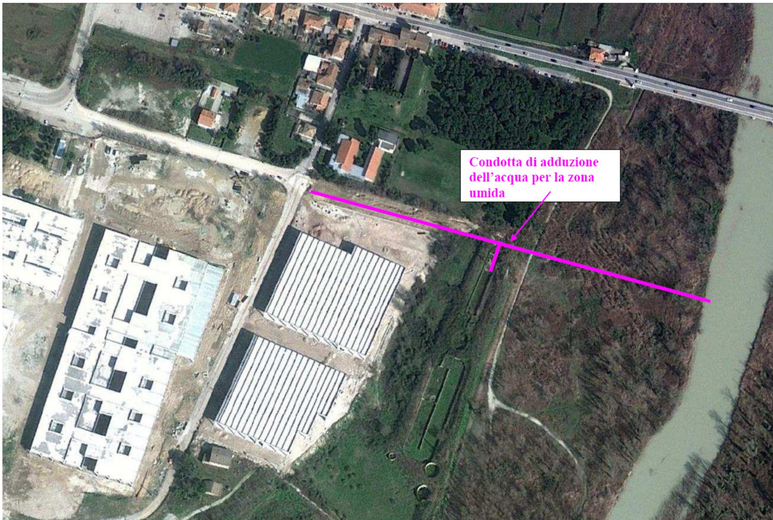
Fig. 1. Posizione indicativa della condotta di alimentazione della vasca primaria tramite le acque di seconda pioggia
