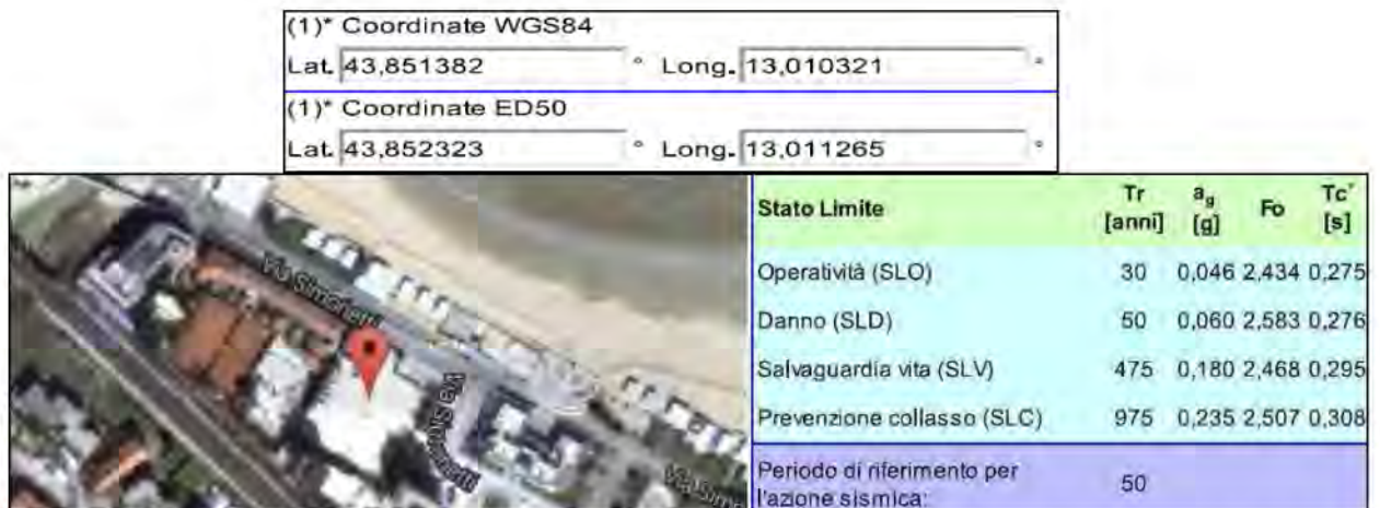
Fig. 8.2.8 Coordinate e valore a_g/g per la zona e la tipologia costruttiva di riferimento (NTC/2008)
