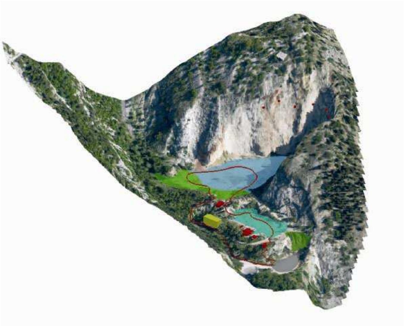
**Fig. 2 - Visione 3D dello schema progettuale per la riqualificazione ambientale della cava n. 001, in loc. Furlo di Acqualagna, che illustra le varie tipologie di intervento ( per la legenda vedi Fig. 1).**
