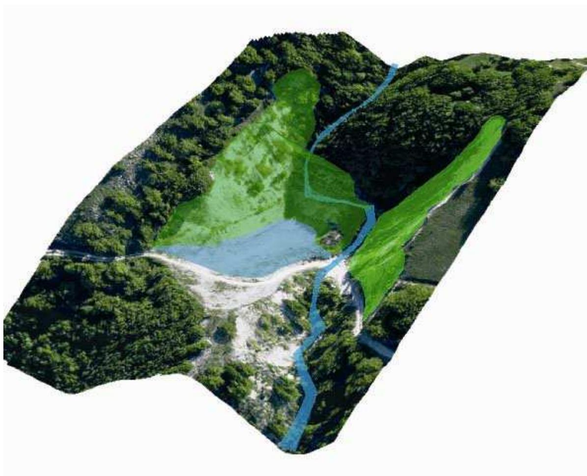
**Fig. 4 - Visione 3D dello schema progettuale per la rinaturalizzazione della cava n. 014 in loc. Col Lungo di Apecchio, che illustra la delimitazione delle differenti aree di intervento (per la legenda vedi Fig. 3).**
