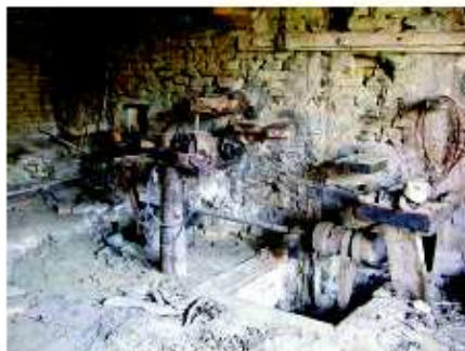
PAIDIRAA FINCO Mulino Cirillo, Urbino. Ripara ideale: contenitori di Domenico Maggi. Si tratta di una ruota primitiva utilizzata per azionare le macchine dell'officina dove i magari costruivano anche i loro arredi di legno.
