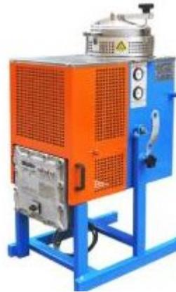
*esempio di apparecchiatura per il recupero dei solventi/diluenti esausti*
